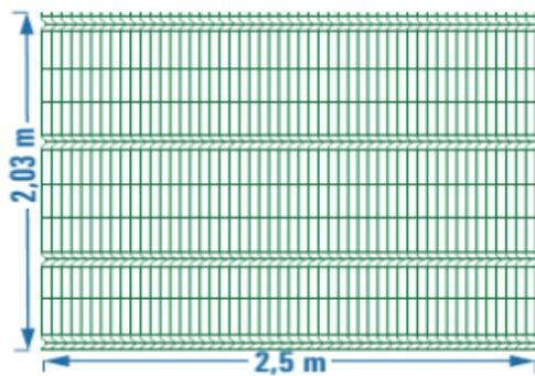
Figura 2 - Dimensões do painel do gradil
